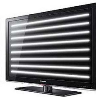
LCD-TV mit CCFL Backlight
